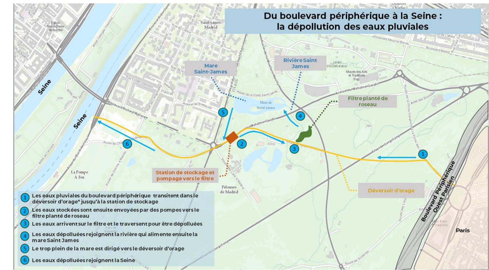
Fig 1. Dispositif du filtre mis en place dans Le Bois de Boulogne
